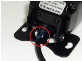
ジャンパー線（左の例では、○で囲った青い電線）を切断することで鏡像から正像に切り換えることができます。切り換え動作は、通電中には行えませんので電源オフの状態で行ってください。ジャンパー線を切断した後は、シリコンコーキング剤などで絶縁・防水処理をしてください。また、ジャンパー線を切断しない場合でもコーキング処理をすれば保護に役立ちます。※一旦切断したジャンパー線はハンダ付け以外では元に戻すことはできませんので、作業は慎重に行ってください。
